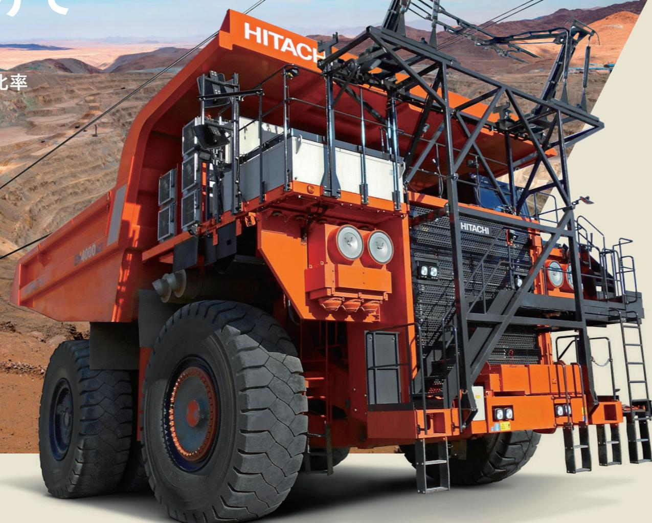
「トロリー充電式」を採用したフル電動リジッドダンプトラック
